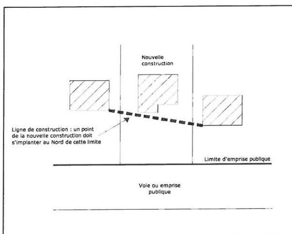
Une implantation « suivant la ligne de construction » signifie qu'un point de la construction doit se trouver sur cette ligne.
